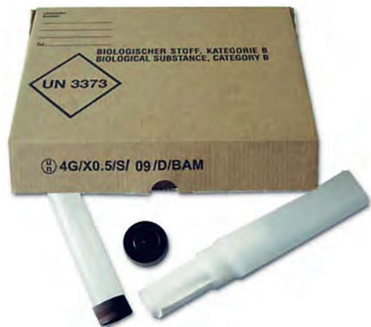
\*) Die abgebildete Kennzeichnung gemäß 6.0.4 IATA-DGR ist ein Beispiel für den Nachweis der Bauartprüfung einer kistenförmigen Verpackung aus Pappe (andere Materialien gemäß IATA-DGR möglich) mit einer Bruttohöchstmasse von 0,5 kg.
